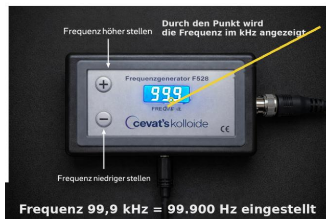
Abbildung 3: Frequenz 99,9 kHz = 99.900 Hz eingestellt (Anzeige 99.9, Punkt zwischen 99 und 9).
