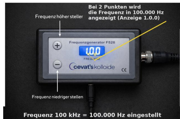
Abbildung 4: Frequenz 100 kHz = 100.000 Hz eingestellt (Anzeige 1.0.0, zwei Punkte).
