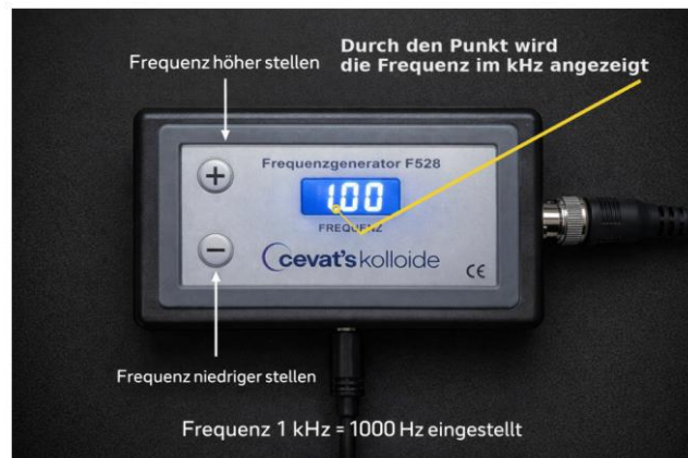
Abbildung 2: Frequenz 1 kHz = 1.000 Hz eingestellt (Anzeige 1.00, Punkt nach der 1).
